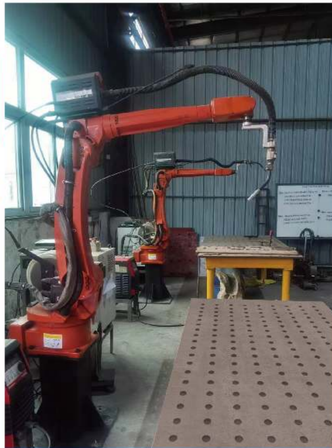
自動點焊機 / Automatic point welding machine
